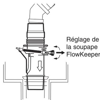
**Installez la soupape FlowKeeper avec la flèche tournée vers le bas en direction du conduit de l'écumoire.**
