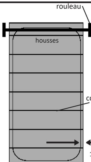
Ouvrez le couvert au-dessus de la piscine. Assurez-vous que le bout de la housse (où il s'attache au rouleau) est carré au rouleau. Lorsque vous coupez la housse, laissez une bordure de 1" autour du bord de la piscine pour compenser pour un rapetissement. Si la housse à des coutures, ces derniers devraient être parallèle au rouleau. (Ceci ne sera pas possible avec certaines housses)
