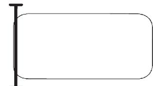
Pour piscines de formes irrégulières, le côté extérieur du tube devrait être à un minimum de 3' à l'intérieur du bord de la piscine. Pour de meilleurs résultats, placez la bobine au point le plus large de la piscine.
