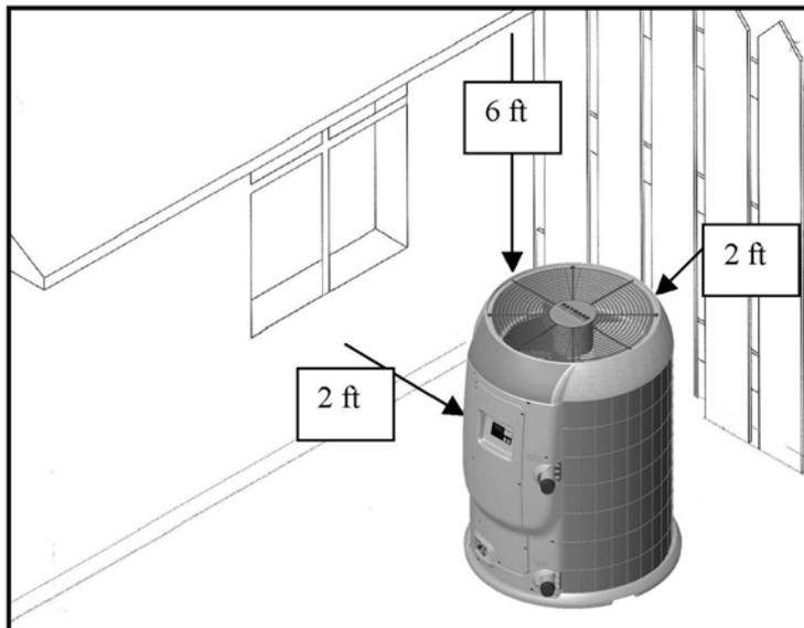
**RE-CIRCULATION OF AIR BACK INTO THE PUMP WILL GREATLY REDUCE ITS EFFICIENCY**
