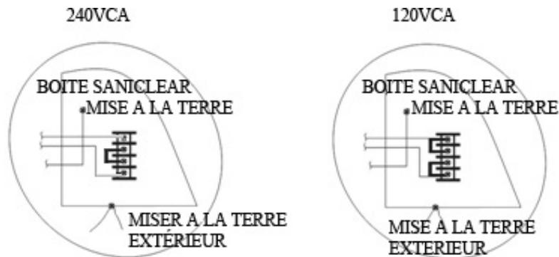
Au bas du boîtier du chlorinateur de sel, il y a une cosse qui doit être utilisée pour la mise à terre de l'unité au système de mise à terre électrique de la piscine en utilisant un fil de cuivre de calibre 8 AWG (6 AWG pour le Canada) (voir schéma ci-dessous).
