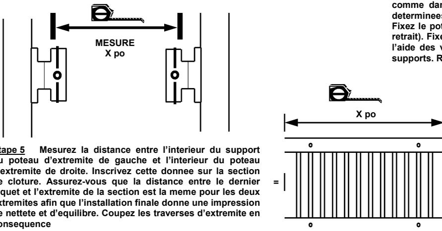
**Etape 5** Mesurez la distance entre l'interieur du support du poteau d'extremite de gauche et l'interieur du poteau d'extremite de droite. Inscrivez cette donnee sur la section de cloture. Assurez-vous que la distance entre le dernier piquet et l'extremite de la section est la meme pour les deux extremités afin que l'installation finale donne une impression de nettete et d'equilibre. Coupez les traverses d'extremite en consequence
