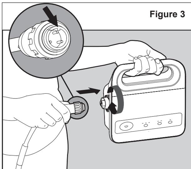
**Figure 3****ÉTAPE 4 :****Branchez le bloc d'alimentation à la source d'alimentation**
