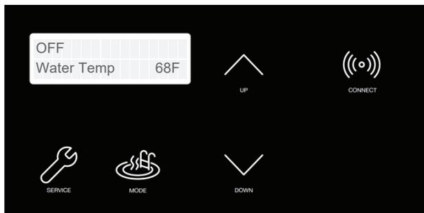
Figure 91. Réinitialisation du Wi-Fi – maintenez la touche CONNECT enfoncée
