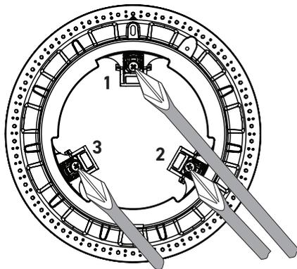
AS THE CAM LOCK SCREWS TIGHTEN, THE CAM LOCKS WILL MOVE IN AND UP, PULLING THE NICHE ADAPTOR FIRMLY INTO THE NICHE
