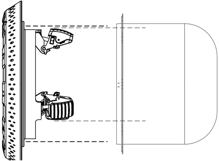
PUSH THE NICHE ADAPTOR INTO THE WALL SO IT SITS FLUSH AND IS FULLY INSERTED INTO THE NICHE
