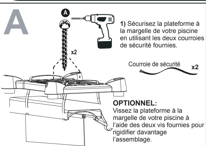
1) Sécurisez la plateforme à la margelle de votre piscine en utilisant les deux courroies de sécurité fournies.
