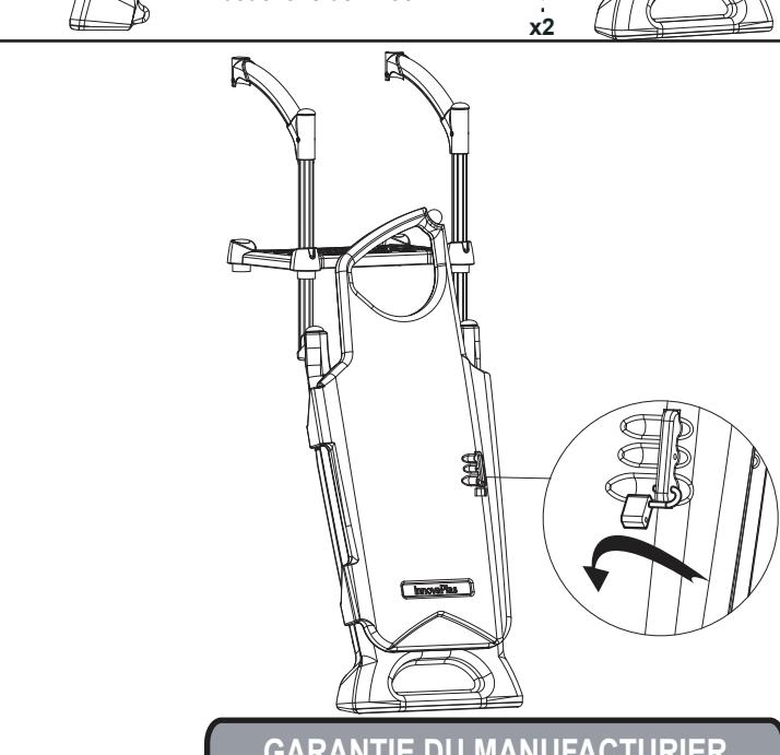
1) Insérez les poteaux de la portière à travers la plateforme et les garde-corps.
