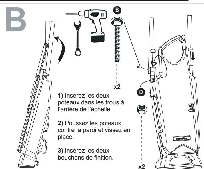
1) Insérez les deux poteaux dans les trous à l'arrière de l'échelle.
