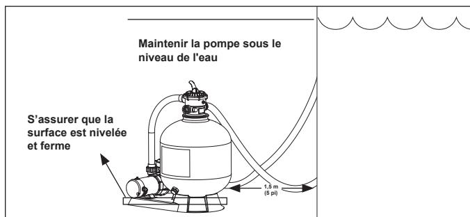
Bien que la pompe soit conçue pour une utilisation en extérieur, il est recommandé que l'installation tienne compte des points suivants :
