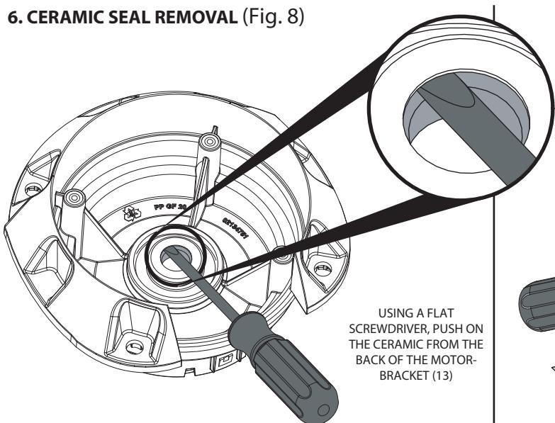
FLAT SURFACE MUST BE ON TOP WHEN REASSEMBLING
