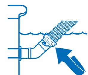
**DEDICATED SUCTION LINE:** Rotate Twist-Lock elbow connector. **LIGNE D'ASPIRATION DÉDIÉE:** Faire pivoter le coude réglable de fixation à rotation. **LÍNEA DE SUCCIÓN EXCLUSIVA:** Gire el conector del codo de giro-bloqueo ajustable.
