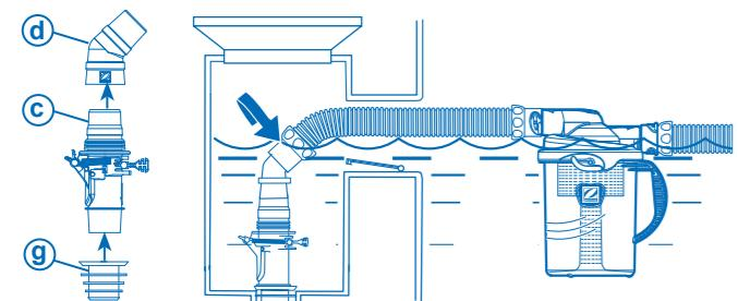
**SKIMMER BASKET:** Rotate hose cuff. **PANIER DE L'ÉCUMOIRE:** Faire pivoter l'embout du tuyau. **EN EL CESTO DE COLECTOR DE BASURA:** Gire el extremo de la manguera.
